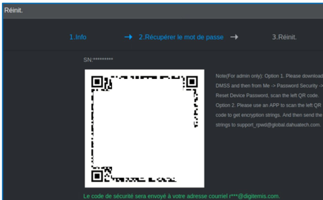
Figure 12 - Procédure de réinitialisation de mot de passe du compte « admin » de l'enregistreur vidéo
