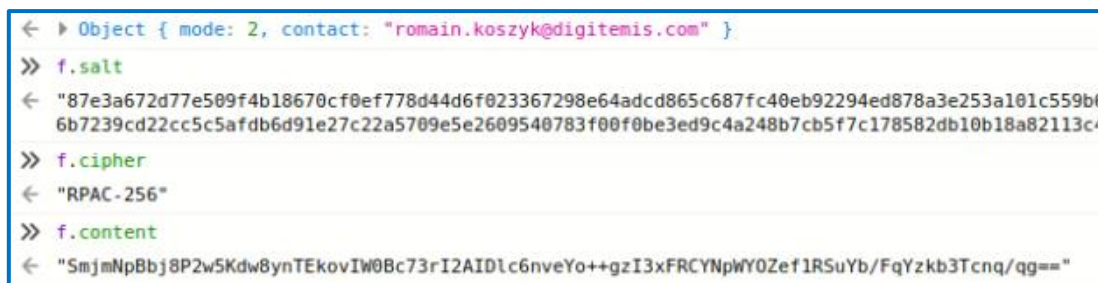
Figure 8 - Récupération des différentes valeurs cryptographiques nécessaires à la modification du mail de contact
