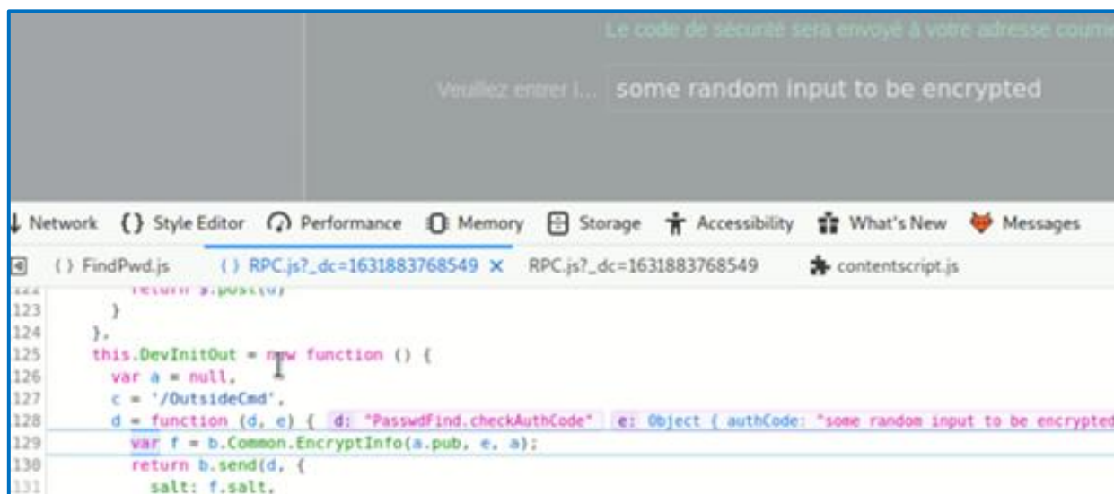
Figure 6 - Mise en pause du flux d'exécution JavaScript lors de la saisie d'un code de sécurité, ici « some random input to be encrypted »
